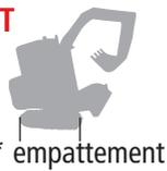
\*Empattement : distance entre les essieux avant et arrière ou longueur de chenilles d'un véhicule - Plus la distance de l'empattement est longue et plus la capacité de charge augmente. Pour les véhicules à chenille il est indispensable d'utiliser des rampes avec au moins 15 % de portée en plus par rapport au poids du même véhicule.
