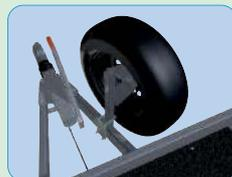
**SUPPORT DE ROUE DE SECOURS SUR FLÈCHE**
