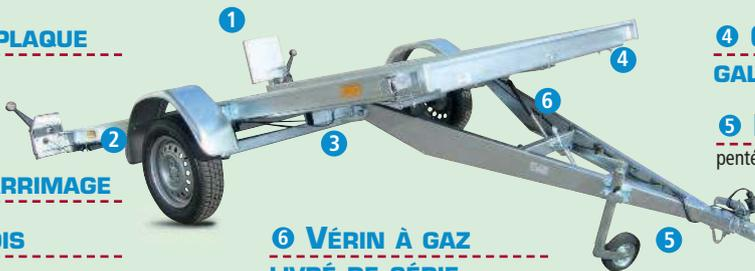
**4 CHÂSSIS SOUDÉ GALVANISÉ À CHAUD**
