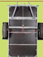
Châssis entièrement mécano-soudé avec traverses de renfort.
