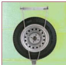
Porte roue de secours sous châssis
